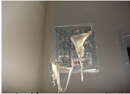
معدلات الأربيجي تتسبب بارتفاع درجة الحرارة كما هو واضح من تسود الجدران وتحطم صندوق الملتقى في غرفة جلوس السيد يوسف محاجب
